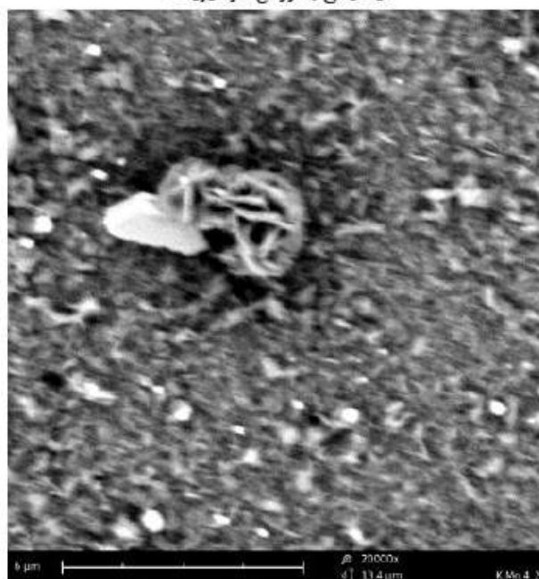
شکل (۳) : تصویر پوشش \text{ZnO} ایجاد شده روی سطح ورقهای نازک مسی به روش شیمی تر
